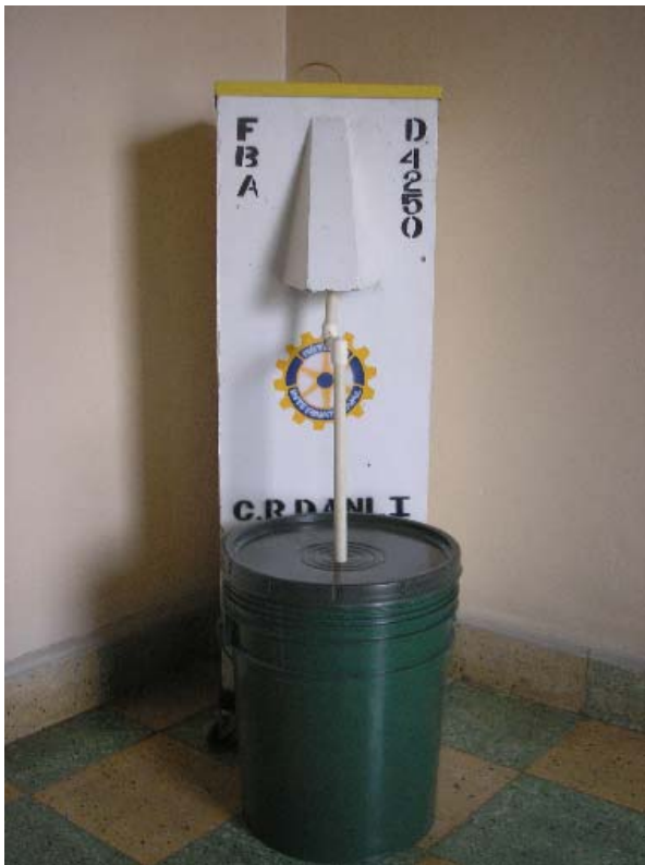
Instalacion de filtro Bioarena en Honduras
